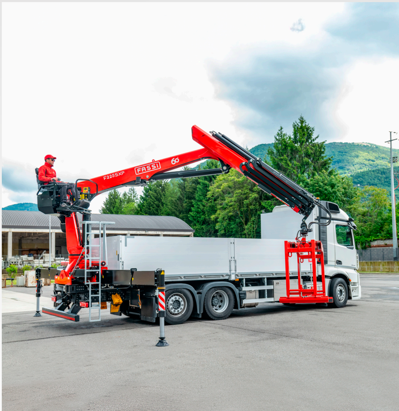
Crane aus der HC1 HD4 S2 Klasse (wenn sie auf Lastwagen montiert) nach EN 12999:2020 - Crane belonging to the HC1 HD4 S2 class (if installed on truck) according to EN 12999:2020 - Grue appartenant à la classe HC1 HD4 S2 (s'il est installé sur le camion) selon la norme EN 12999: 2020
