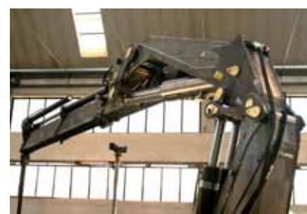
Une zone spécifique des établissements Fassi d'Albino est entièrement consacrée aux tests prévus par les tests de fatigue, organisés en de multiples postes qui soumettent les prototypes aux essais de réception expérimentaux les plus sévères.
