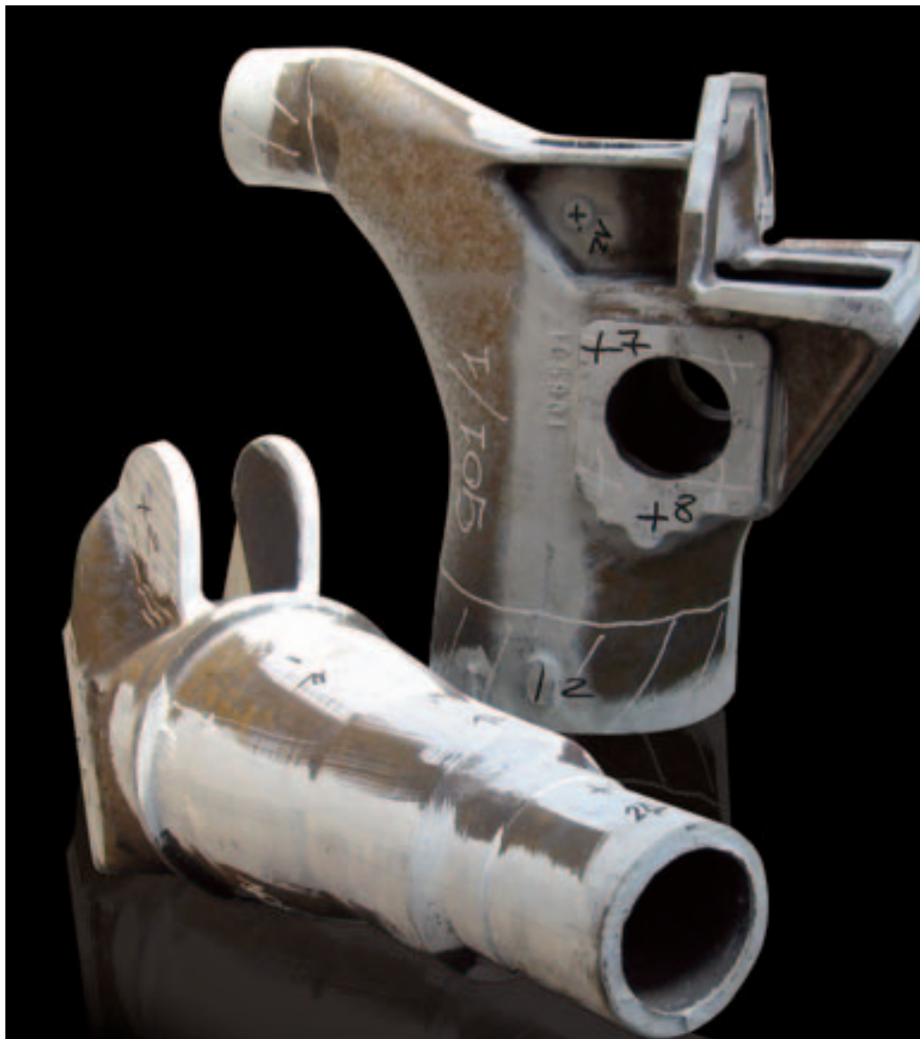
In queste immagini due monoblocchi in fusione del basamento e della colonna dopo la verifica: le zone chiare indicano il controllo dimensionale tramite tracciatura, i punti evidenziati segnalano le zone radiografate. I controlli permettono di rilevare la conformità dimensionale ed individuare difetti interni.
