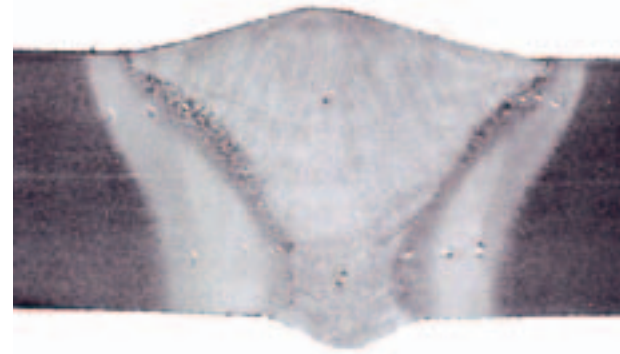
Tramite macrografia Fassi verifica la conformità delle saldature eseguite. In questo caso si notano due passate di saldature eseguite in modo corretto e quindi conforme all'omologa Fassi.
