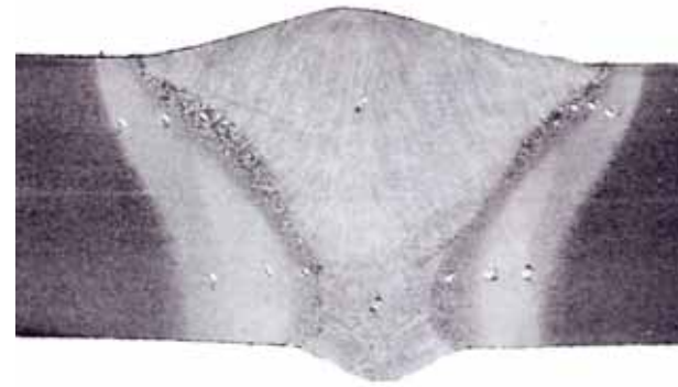
Através da macrografia, a Fassi comprova a conformidade das soldaduras efectuadas. Neste caso notam-se duas soldaduras que foram realizadas de forma correcta, e portanto estão de acordo com os requisitos da Fassi.
