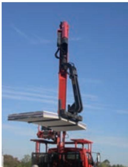
*L'utilisation de fourches spécifiques facilite et accélère les tâches de levage des panneaux et des palettes, en permettant d'atteindre les fenêtres et les ouvertures des bâtiments et en portant avec précision les matériaux à des endroits quasi-inaccessibles pour les autres technologies.*
