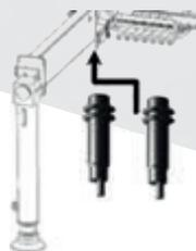
L'individuazione della condizione di martinetto stabilizzatore a terra è demandata all'installazione di un secondo sensore di prossimità, la cui sede è già predisposta su tutte le traverse gru e supplementari.
