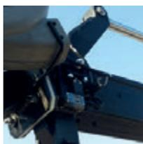
La normativa EN 280:2015 prescrive che le piattaforme intercambiabili debbano essere bloccate e interbloccate sulla struttura estensibile. Questo significa che, oltre ad un perno che blocchi la piattaforma alla gru, è necessario un controllo elettronico della presenza di tale perno.
