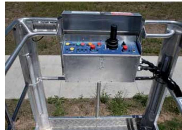
vehículo directamente desde la plataforma a través del joystick instalado en la consola de mando que actúa mediante un cambio hidrostático montado sobre la transmisión cardánica del motor.
