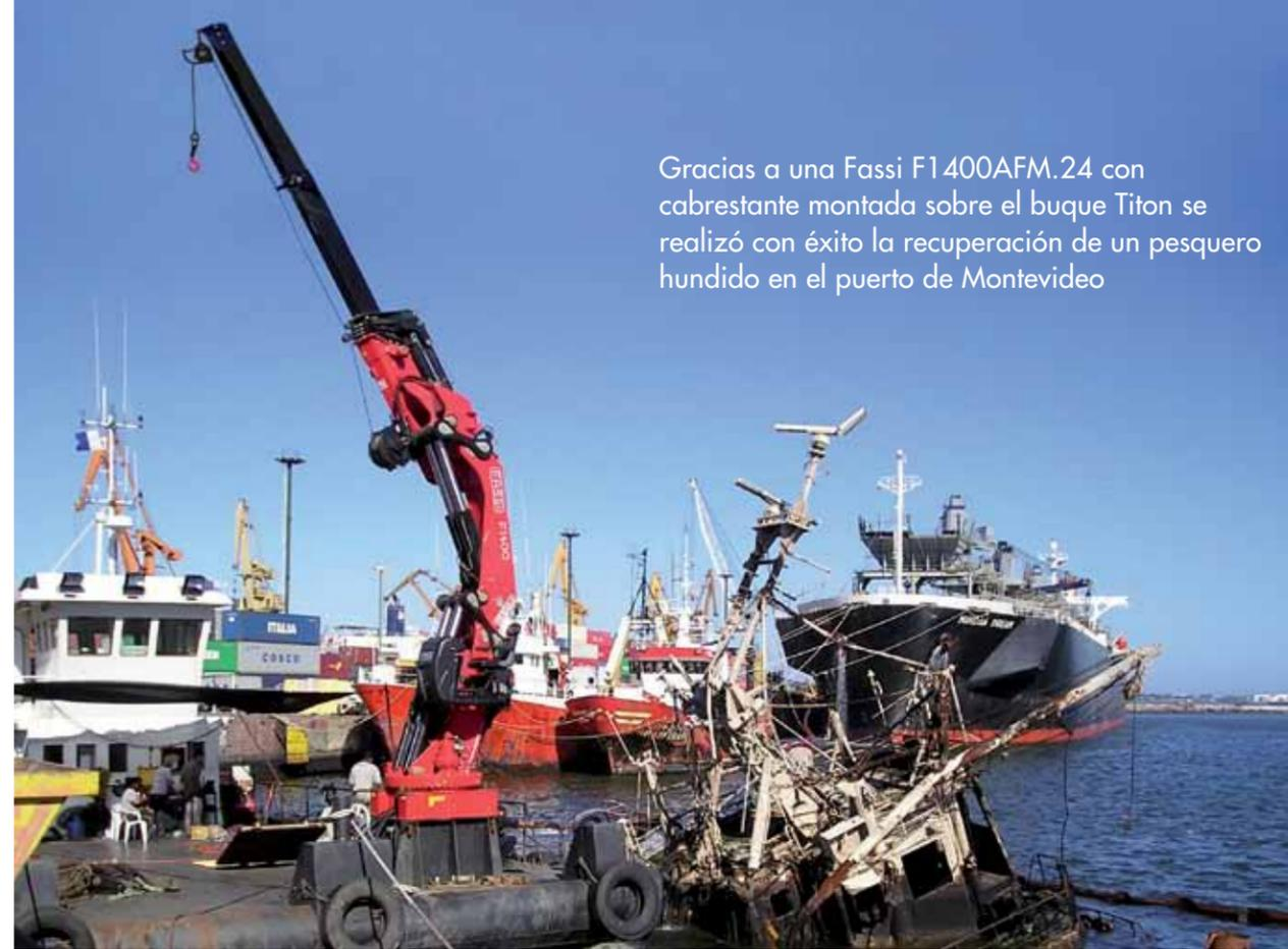
Gracias a una Fassi F1400AFM.24 con cabrestante montada sobre el buque Titon se realizó con éxito la recuperación de un pesquero hundido en el puerto de Montevideo
