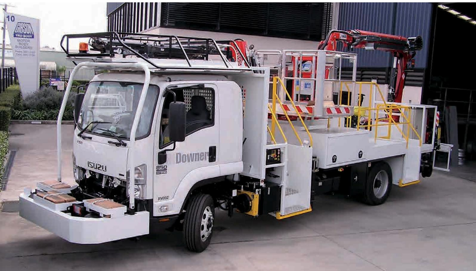
Fahrzeugaufbaus auf einen Isuzu FSR 850 mit langem Radstand eng mit Gibson Tru-Body zusammen. Eine Einheit, die sich sowohl auf der Straße als auch auf mehrspurigen Schienenanlagen bewegen kann.
