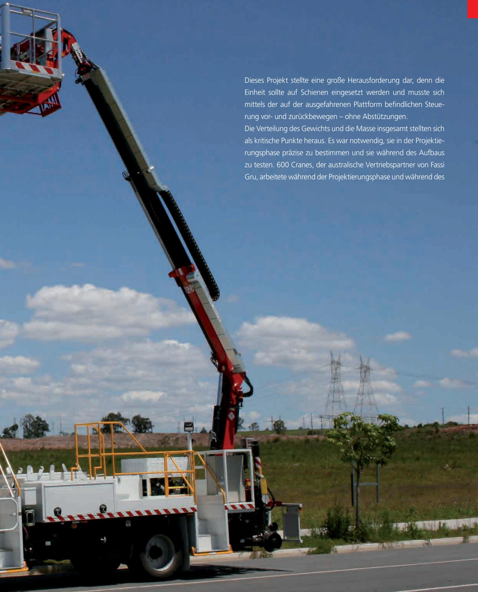
Dieses Projekt stellte eine große Herausforderung dar, denn die Einheit sollte auf Schienen eingesetzt werden und musste sich mittels der auf der ausgefahrenen Plattform befindlichen Steuerung vor- und zurückbewegen – ohne Abstützungen.
