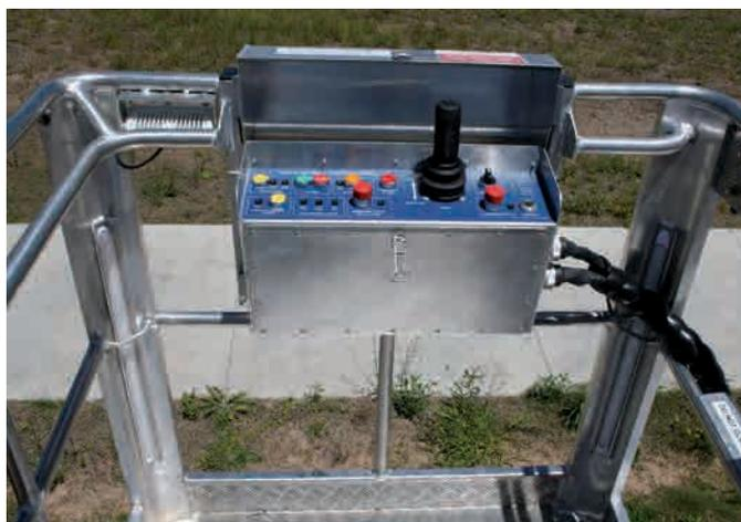
tforn befindliche Steuerung erfolgt das Führen des Fahrzeugs direkt von der Plattform aus. Hierfür wird ein Joystick verwendet, der auf der Steuerungskonsole zu finden ist. Dieser arbeitet mit einem hydrostatischen Getriebe auf der Kardanwelle des Motors.
