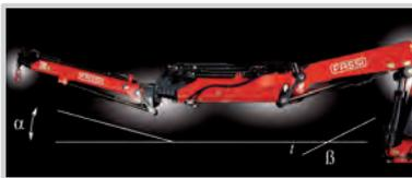
**Prolink-System, XF-Ventil, Patent für den Drehmomentbegrenzer für die Winde sowie den Drehmomentbegrenzer für manuelle Ausschübe**
