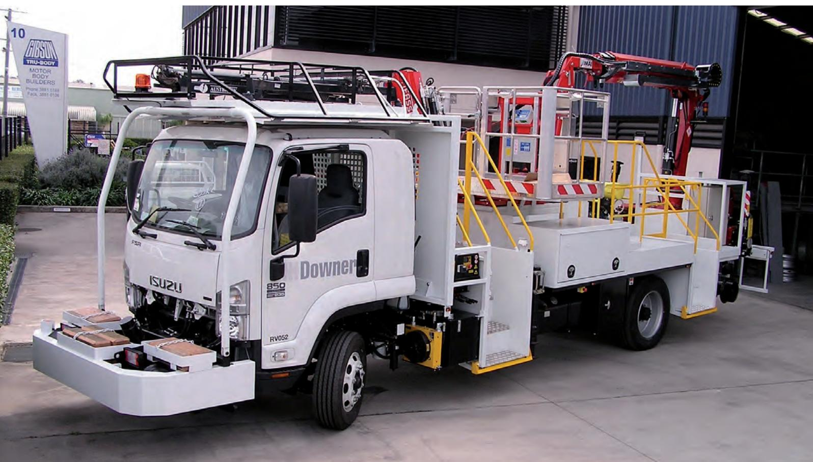
phases de conception et d'installation du véhicule Isuzu FSR 850 à pas long. Une unité en mesure de voyager sur route et sur voie ferrée à plusieurs écartements.
