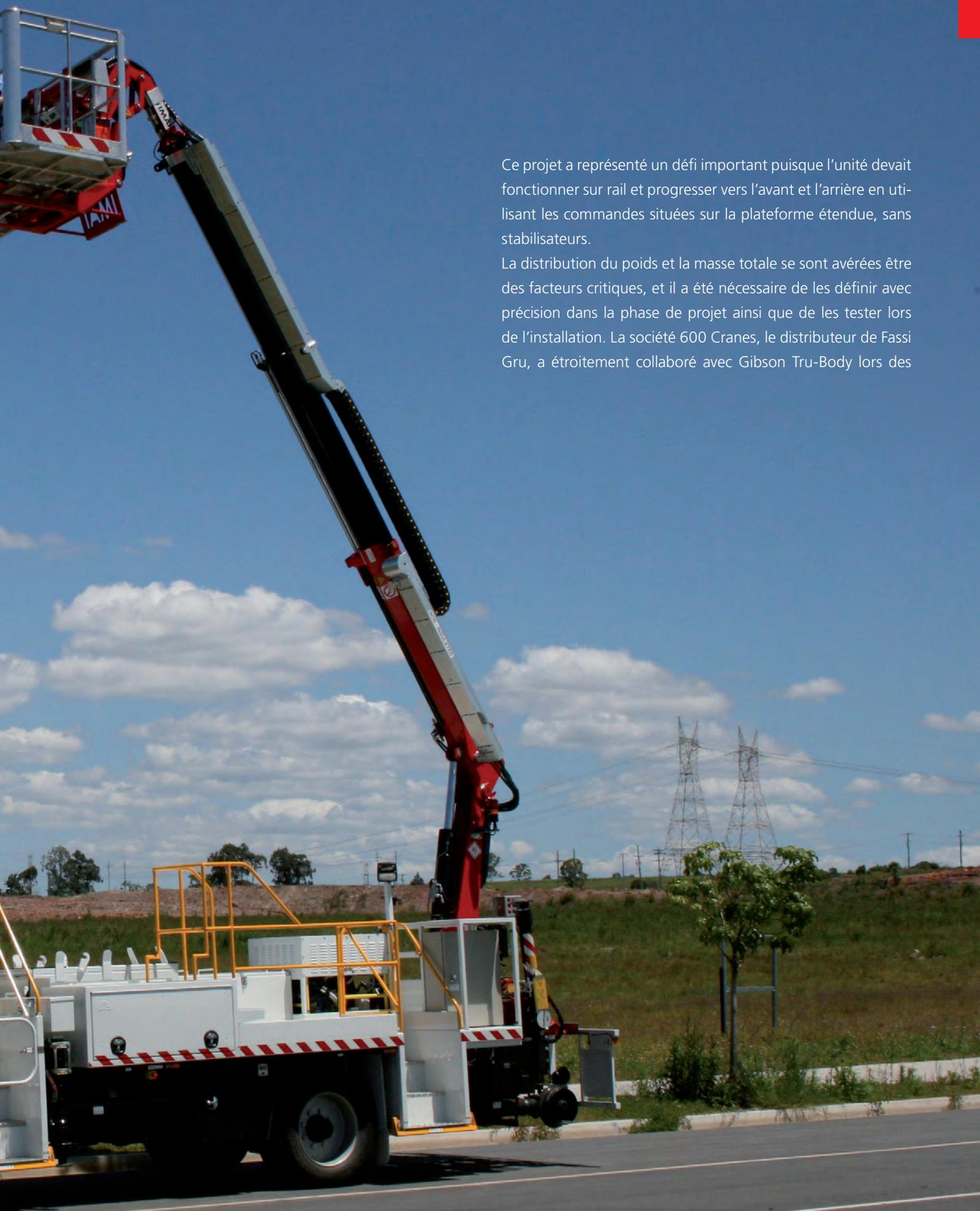
Ce projet a représenté un défi important puisque l'unité devait fonctionner sur rail et progresser vers l'avant et l'arrière en utilisant les commandes situées sur la plateforme étendue, sans stabilisateurs.
