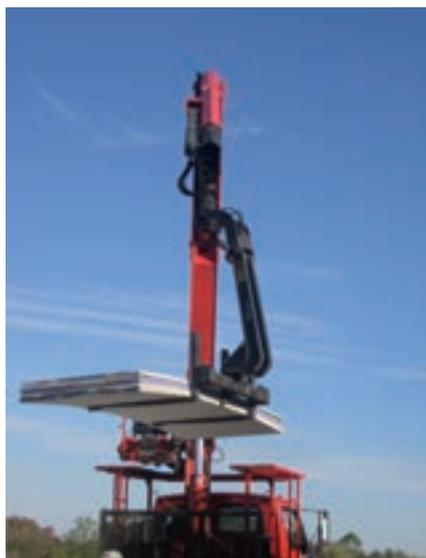
*La utilización de horquillas adecuadas agiliza y acelera después la velocidad de trabajo de elevación de paneles y palets, lo que permite alcanzar ventanas y aperturas de los edificios y llevar con precisión los materiales a lugares casi imposibles para otras tecnologías.*
