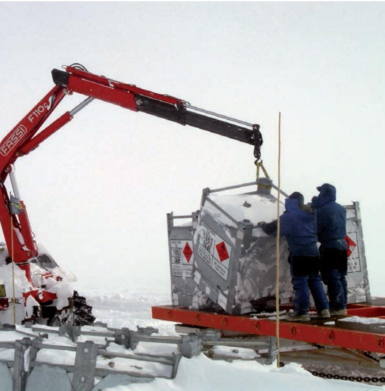
empleadas en las operaciones de carga y descarga (625 t de mercancías manipuladas), necesarias para la construcción de la Kunlun Station además de para las operaciones especiales como la recuperación de otros vehículos y, usadas en pareja, para la elevación de estructuras de grandes dimensiones como los contenedores.
