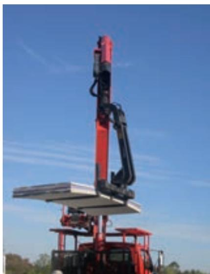
*L'utilizzo di apposite forche agevola e velocizza ulteriormente il lavoro di sollevamento di pannelli e pallet, consentendo di raggiungere finestre e aperture negli edifici, portando con precisione i materiali dove sarebbe quasi impossibile per altre tecnologie.*
