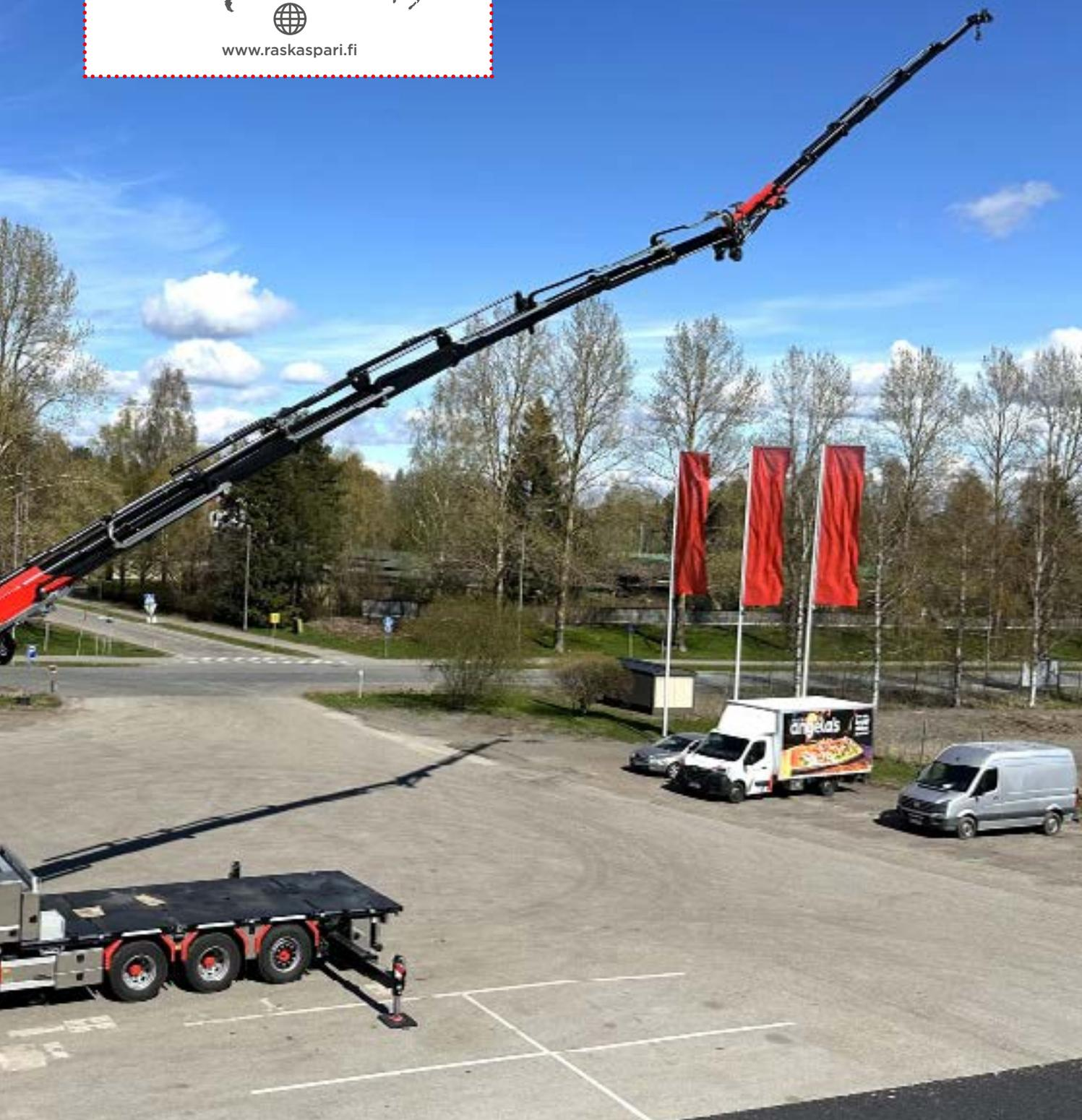
La Fassi F1250R-HXP, avec ses neuf flèches, est la première de ce type en Finlande. Weber a ajouté : « La grue à neuf extensions a une portée horizontale de plus de 21 mètres. Elle présente un excellent rapport poids/puissance et comprend des fonctions avancées telles que le contrôle de stabilité FSC TECHNO. »
