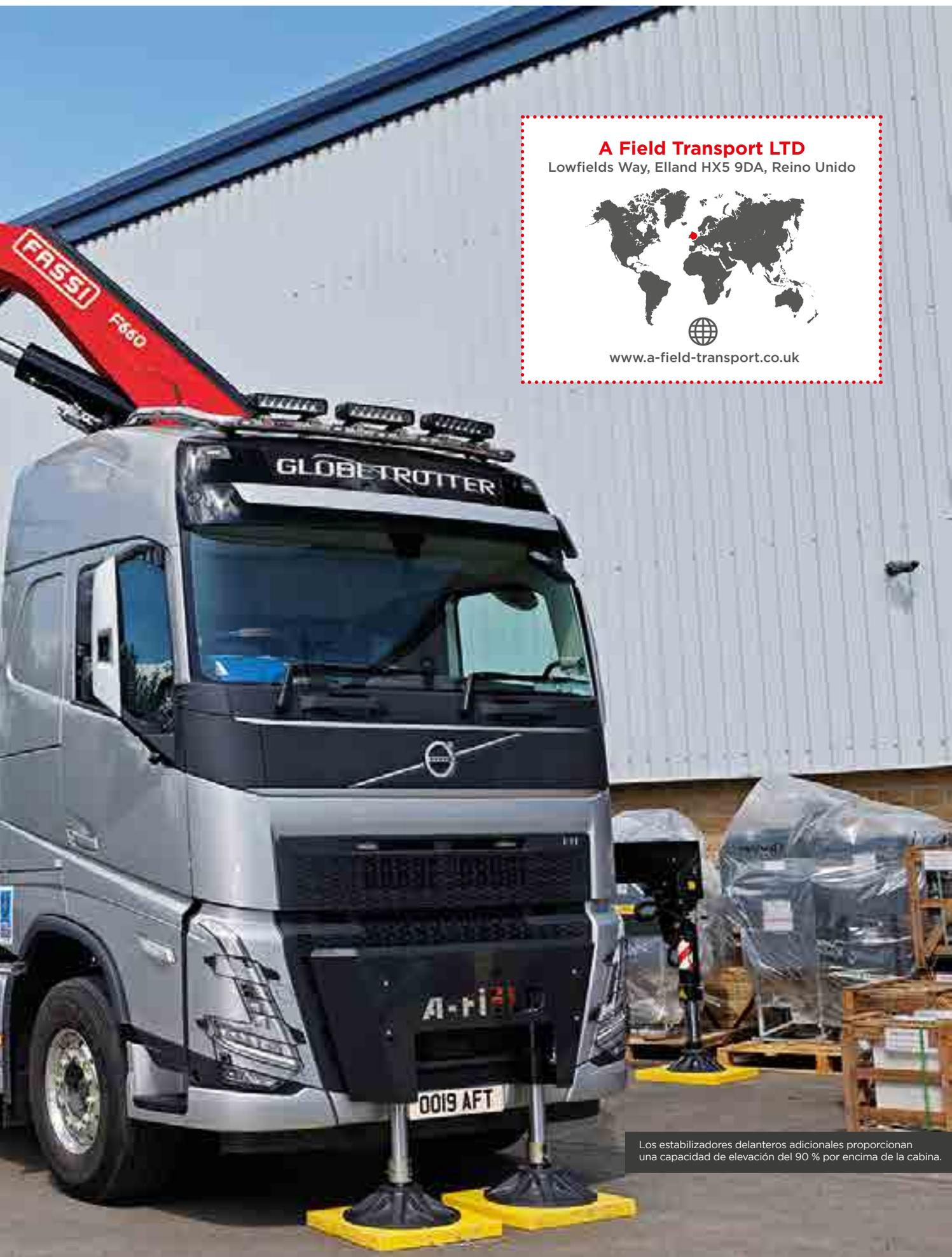
Los estabilizadores delanteros adicionales proporcionan una capacidad de elevación del 90 % por encima de la cabina.
