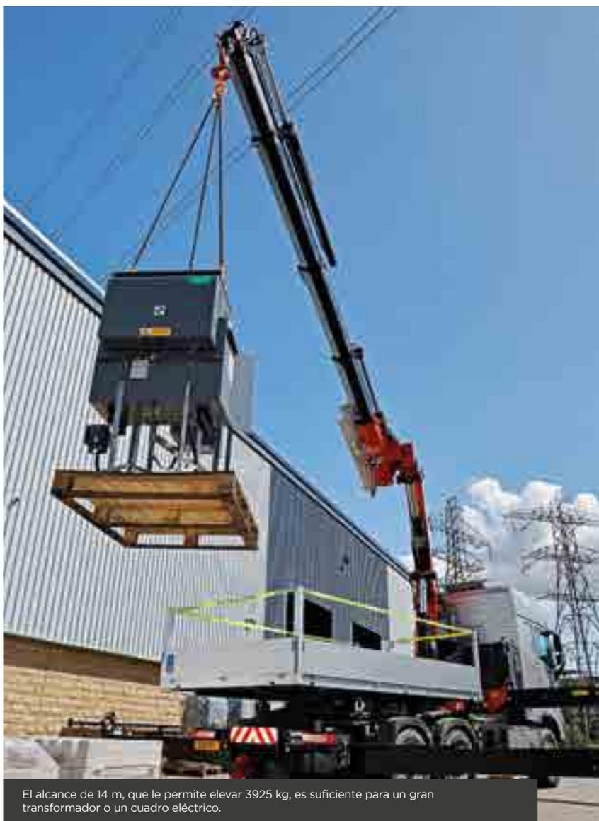
El alcance de 14 m, que le permite elevar 3925 kg, es suficiente para un gran transformador o un cuadro eléctrico.
