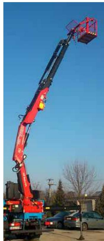
Il est désormais possible d'équiper une plate-forme élévatrice de travail (PLE) avec des grues Fassi standard grâce à une seule commande. Un seul sélecteur pour activer le dispositif PSC (Platform Stability Control), et la grue Fassi est prête à être utilisée en mode PLE.
