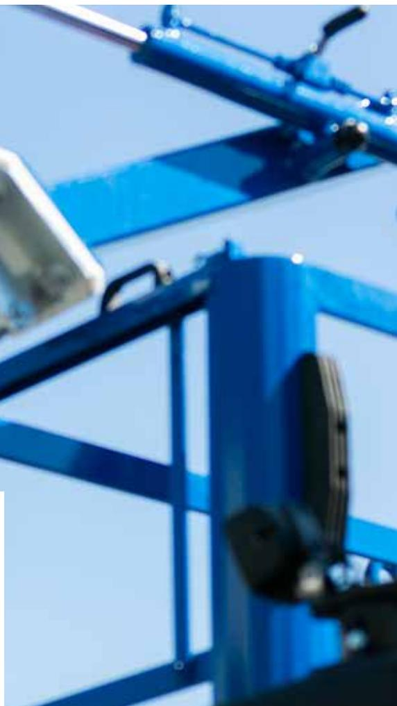
**A**hora es posible instalar una plataforma de trabajo elevable (PLE) en las grúas Fassi estándar gracias a un único comando. Un único selector para activar el dispositivo de control de estabilidad de la plataforma (PSC) y la grúa Fassi estará lista para utilizarse en modo PLE.
