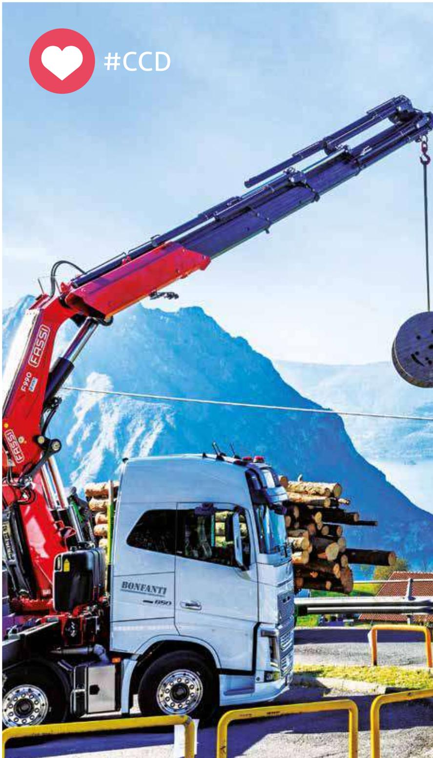
**L**a CCD, siglas en inglés de “Cabin Collision Detection” o detección de colisiones con la cabina, ofrece una mayor garantía de seguridad, eficacia operativa y protección de la integridad del camión.
