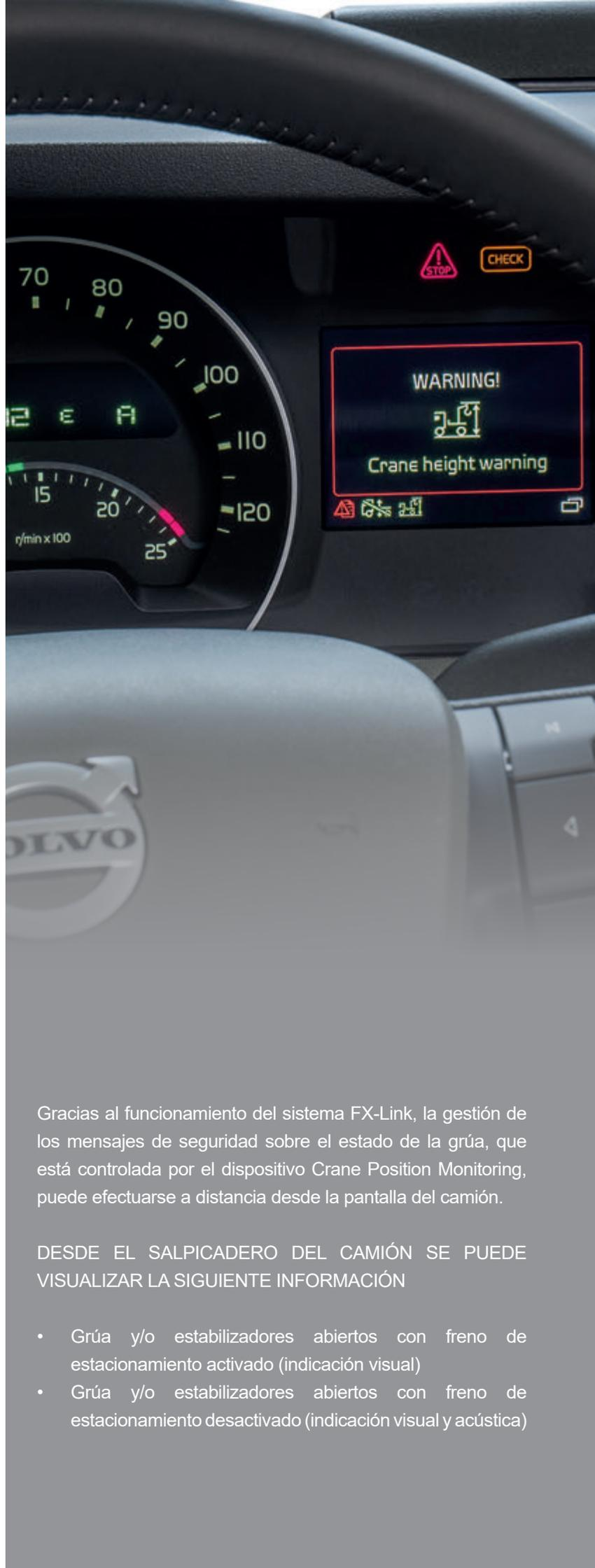
Gracias al funcionamiento del sistema FX-Link, la gestión de los mensajes de seguridad sobre el estado de la grúa, que está controlada por el dispositivo Crane Position Monitoring, puede efectuarse a distancia desde la pantalla del camión.
