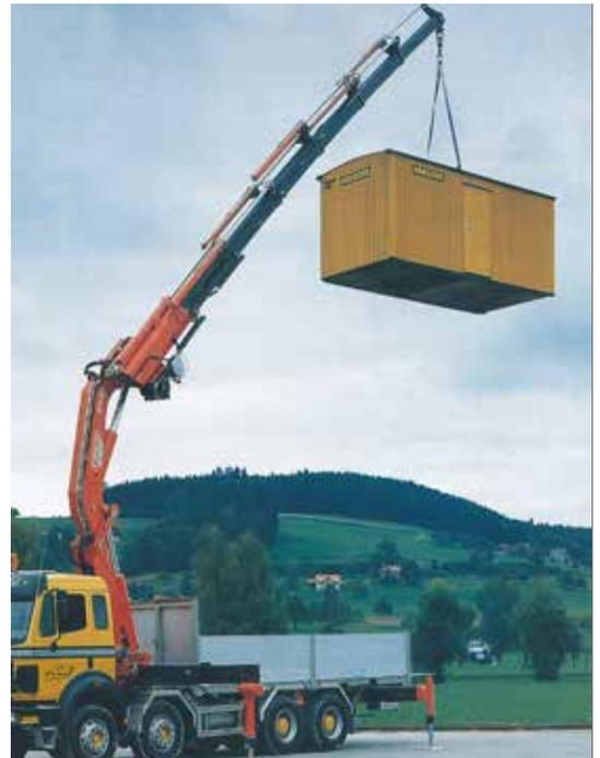
A primeira grua com 8 extensões hidráulicas, a F460, chega ao mercado, equipada com uma extensão hidráulica dobrável (JIB). Este tipo de grua é perfeita para a montagem de elementos pré-fabricados, construções industriais e mudanças industriais.
