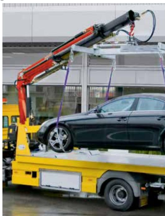
Fassi apresenta a nova Série T: gruas particularmente adequadas para instalação em camiões de reboque para operações de salvamento em estrada e remoção de automóveis, combinados com acessórios específicos para elevação de veículos.
