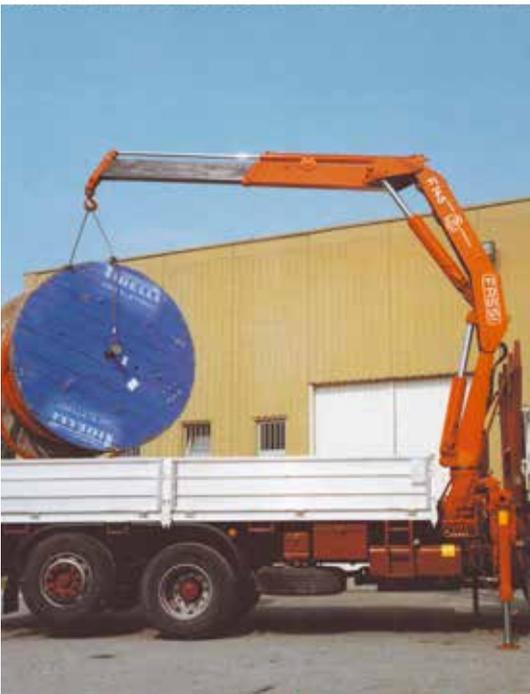
Modelo que adota o sistema patenteado Hiab e que vai ao lado do modelo F145, posicionando-se no segmento imediatamente superior no que diz respeito a capacidade de elevação. Substitui modelos M5 e F5. A grua tem uma base feita de aço fundido, projetado pelo engenheiro Sr. Guidetti da empresa concorrente PM.
