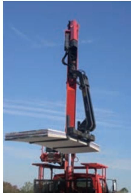
*Der Einsatz von speziellen Gabeln erleichtert und beschleunigt die Hubarbeit an Paneelen und Paletten. Außerdem können Fenster und Öffnungen in Gebäuden erreicht und Materialien ganz präzise an Stellen manövriert werden, die für andere Technologien so gut wie unzugänglich wären.*
