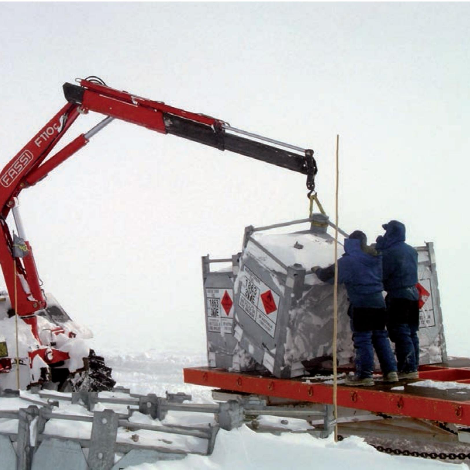
Bau von Kunlun Station. Darüber hinaus erledigen sie Sonderaufgaben wie die Bergung anderer Fahrzeuge sowie, in Kombination mit weiteren Maschinen, das Heben von besonders sperrigen Teilen wie Containern.
