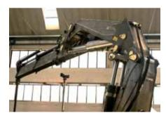
Bei Fassi in Albino ist ein kompletter Bereich für die Ermüdungstests reserviert. Diese werden in den verschiedensten Aufstellungen durchgeführt und es gelten strengste Maßstäbe, wenn die Prototypen den diversen Kontrollen und Versuchen unterzogen werden.
