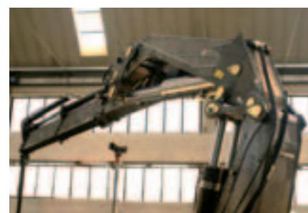
Una specifica area degli stabilimenti Fassi di Albino è dedicata interamente ai test previsti dalle prove a fatica, organizzate in molteplici postazioni che sottopongono i prototipi ai più severi collaudi sperimentativi.
