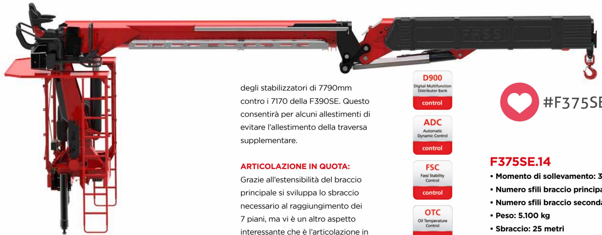
degli stabilizzatori di 7790mm contro i 7170 della F390SE. Questo consentirà per alcuni allestimenti di evitare l'allestimento della traversa supplementare.
