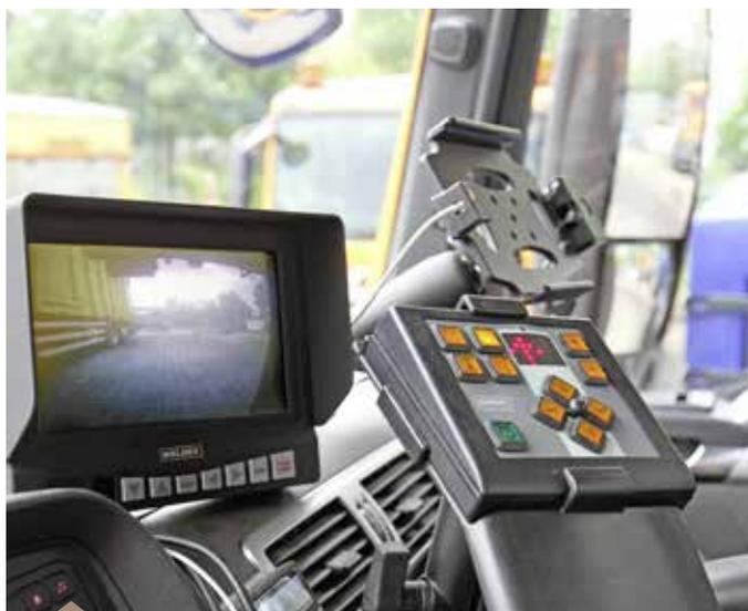
MAN-Cockpit mit Rückfahrmonitor und zahlreichen Bedienpanels für unterschiedlichste Anbaugeräte
