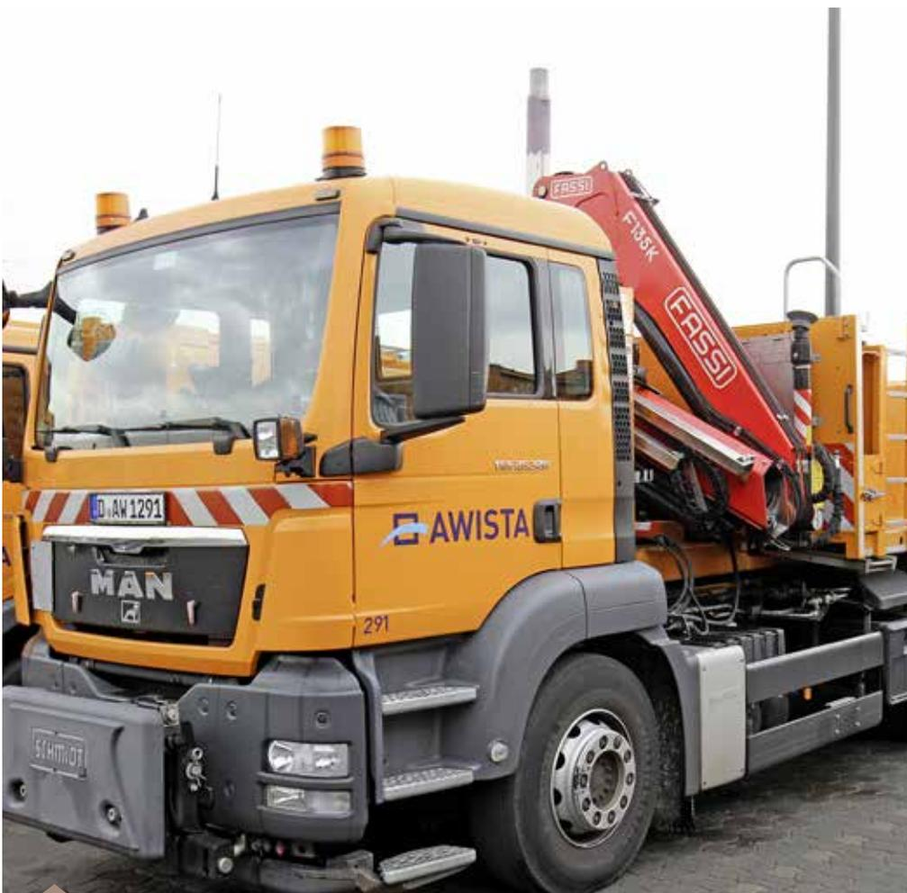
Der TGS 26.320 mit Plateauf Aufbau Fassi-F1 35K-Ladekran dient zum Transport von Altpapier- und Glasbehältern
