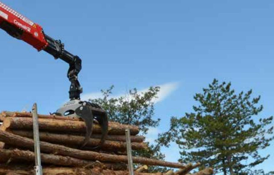
Der Cranab TZ12 ist auf einem Mercedes-Benz Arocs 2551 6x2 aufgebaut, der auf der Vorderachse mit dem Hydraulic Auxiliary Drive ausgestattet ist
