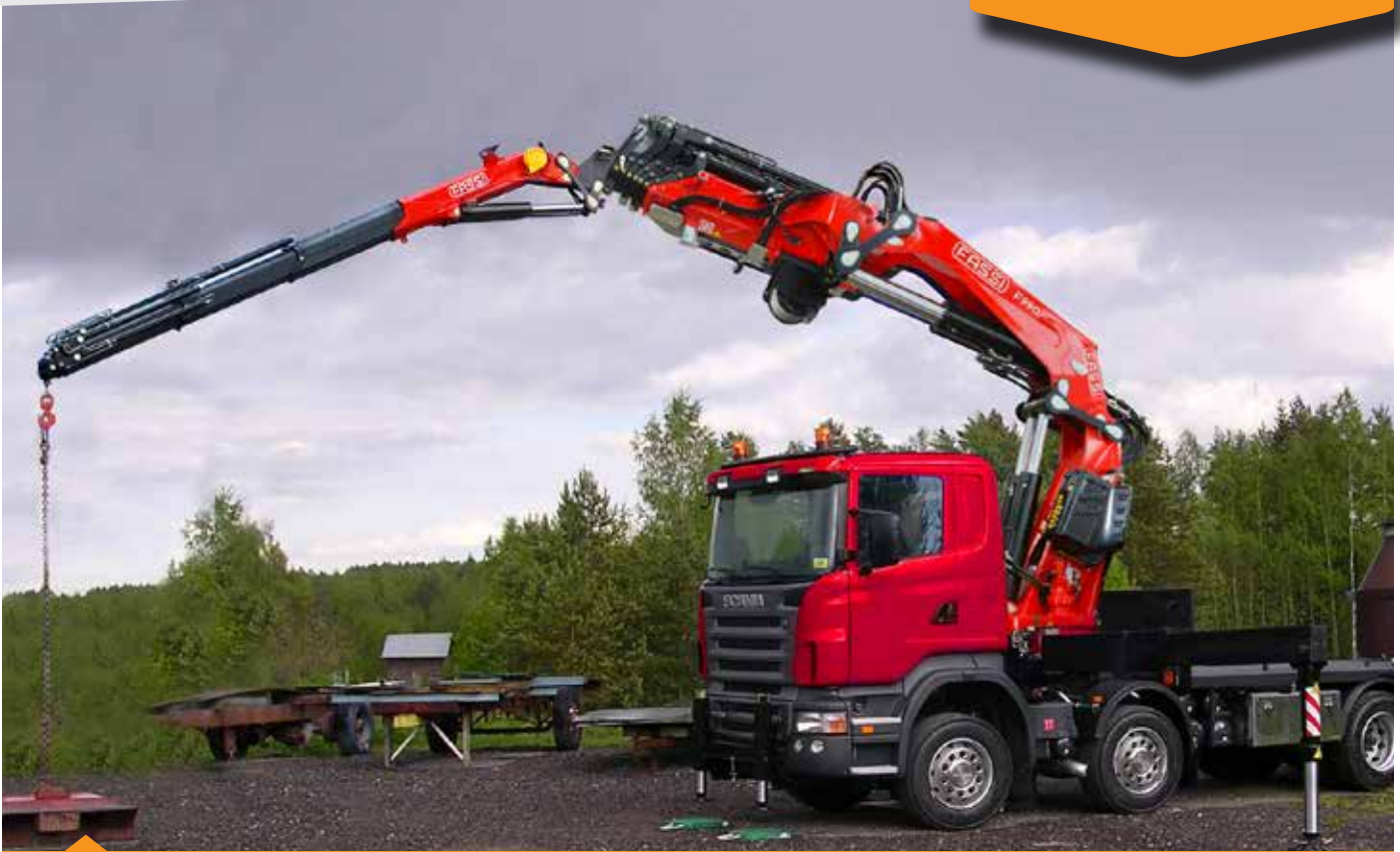
Der F990RA in Aktion. Der neue Fassi Kran ist mit der FX900 Elektronik und FX901 Anzeigepanel ausgestattet
