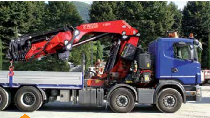
Die F1550RA bietet eine Tragkraft von 123,13 mt
