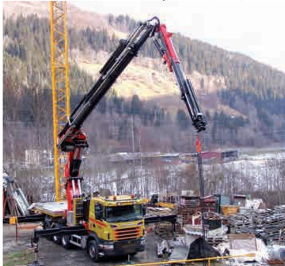
disponía– se pueden efectuar ahora con la nueva grúa de carga. Además se pueden elevar cargas muy pesadas y depositarlas a mayor distancia de los pasos transitables.
