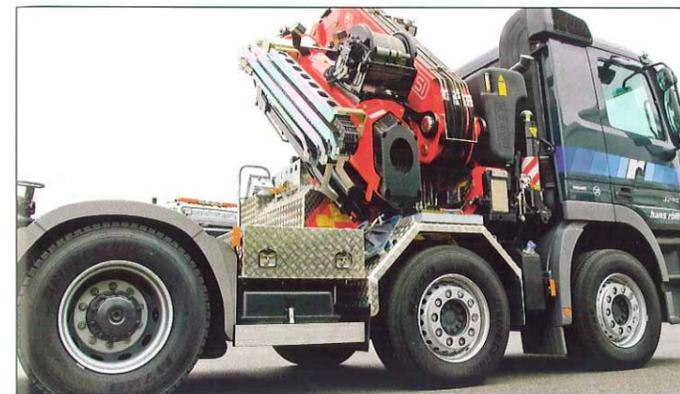
*Kranpaket: Der Fassi-Kran wiegt allein über elf Tonnen. Alles ist eng, aber funktional verbaut.*
