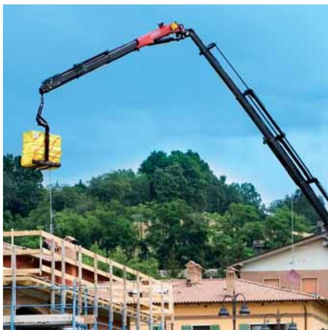
*Mit Zusatzknickarmen von Fassi lassen sich die Möglichkeiten des Fassi-Prolinksystems voll ausschöpfen. Werden sie eingesetzt, kann sich beim Knickarm der Arbeitswinkel über die Horizontale hinaus um ein beachtliches Stück erweitern. Mit Zusatzknickarm kann diese Erweiterung je nach Modell bis zu 20 Grad betragen.*
