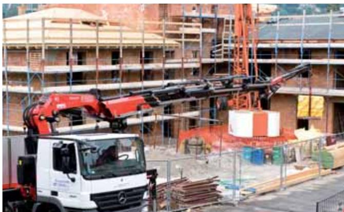
Zusatzknickarm mit seiner Standardleistung, wenn aber nicht alle ausgefahren sind und das JDP-System aktiviert wird, nimmt die Leistung erheblich zu.
