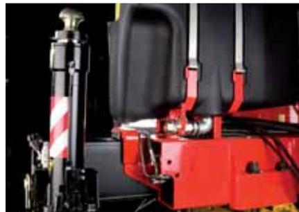
Con esta grúa Fassi amplía y valoriza más la oferta en la franja de las 80 t a las 100 t, gamma en la que la empresa disfruta de una posición destacada por sus diseños y su calidad. Gracias al momento de elevación máxima de 80,1 t y a su tara de solo 7.300 kilos (en la versión .24), este modelo "Evolution" ha alcanzado el primer lugar del podio por la mejor relación peso/potencia de su categoría. De ahí que sea una auténtica referencia en el mercado.
