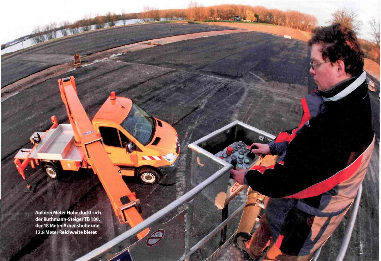
Auf drei Meter Höhe duckt sich der Ruthmann-Steiger TB 180, der 18 Meter Arbeitshöhe und 12,8 Meter Reichweite bietet
