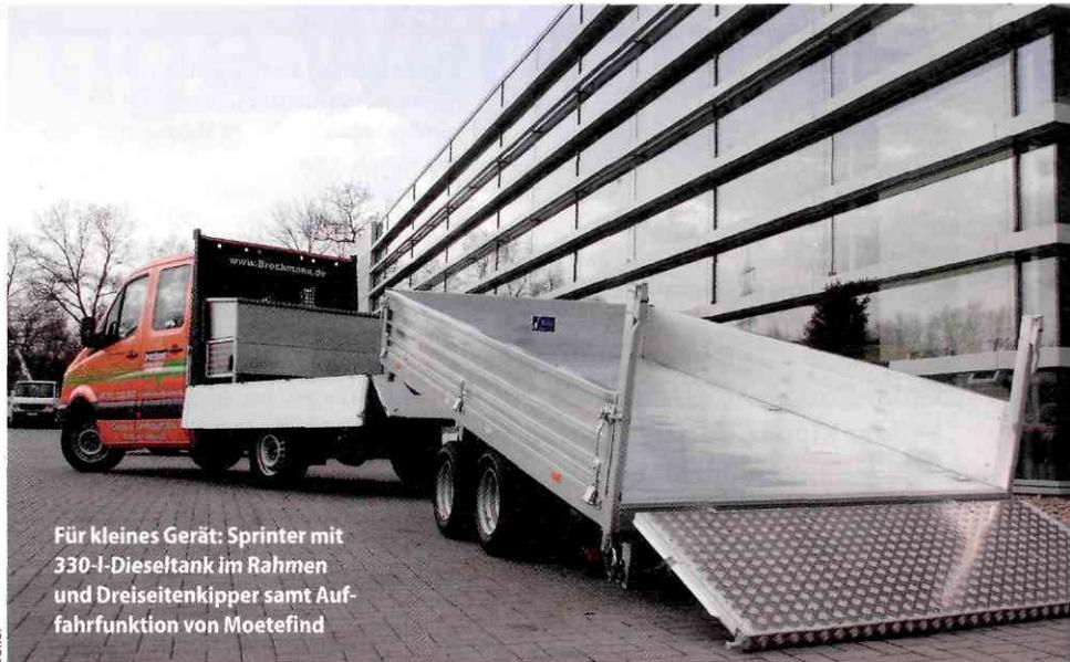
Für kleines Gerät: Sprinter mit 330-l-Dieseltank im Rahmen und Dreiseitenkipper samt Auf-fahr-funktion von Moetefind
