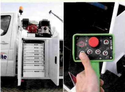
Aufgeräumt: Seitliche Werkzeugschübe, magnetische Kranfernbedienung
