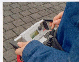
Die Kranfunksteuerung hat zusätzlich ein großes analog anzeigendes Display.
