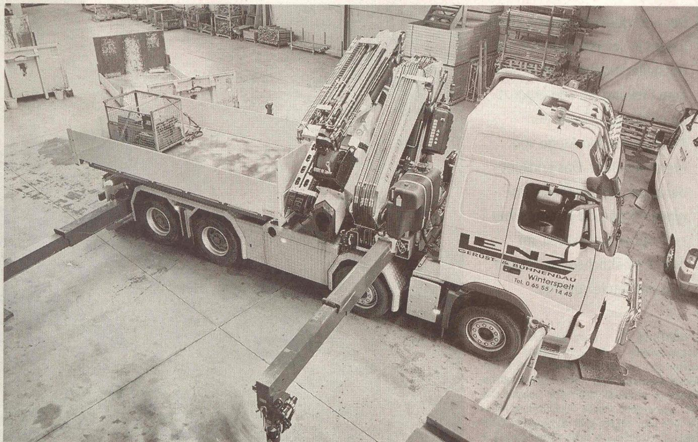
Über der Sattelkupplung kann auf dem Lkw-Kranfahrzeug auch eine Pritsche gesetzt werden.
