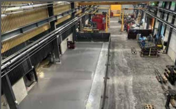
Der für die Metallbearbeitung vorgesehene Bereich nimmt langsam Gestalt an. Vor kurzem wurde ein spezieller Fußboden für die neue Bohrmaschine verlegt, die in den kommenden Monaten geliefert werden soll.
