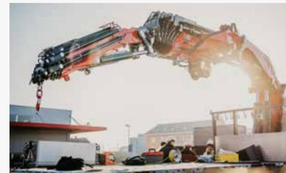
die ausgehend von der Standsicherheit die Ausnutzung der Arbeitsbereiche zugunsten der Hubkapazität überwacht und sie an die jeweiligen Bedürfnisse anpasst. Das neue Dekagonal-Profil von Knickarm und Teleskopauszügen unterstützt aktiv die Leistung des Vertikalhubs; der doppelt gespeiste Hydraulikkreis verbessert die Geschwindigkeit.
