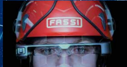
Da una parte l'operatore che indossa un paio di smart glasses dotati di telecamera, dall'altra, anche a centinaia di migliaia di chilometri, un tecnico dell'assistenza ufficiale Fassi che, collegato via internet e sfruttando la visione della telecamera sugli occhiali, lo guida in una serie di operazioni per risolvere eventuali criticità.
