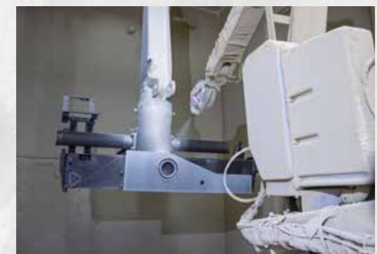
Le vernici sono formate da smalto poliuretano con fondo epossidico ad acqua e sono prive di cadmio, piombo e solventi. Si tratta quindi di vernici atossiche, non infiammabili e inodori, caratteristiche che portano a un miglioramento dell'ambiente di lavoro e alla riduzione al minimo dell'emissione di sostanze prodotte dalle lavorazioni.
