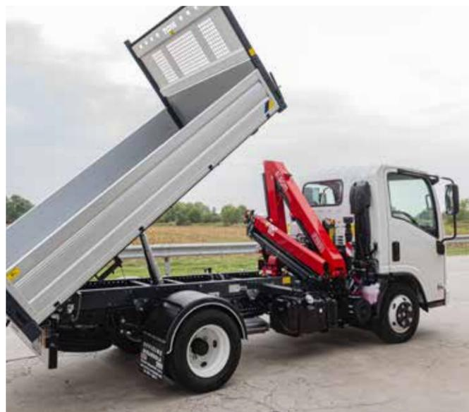
Der neue F30M.0 ist leichter und leistungsstärker als der F30CY.0, der Ausgangspunkt für Entwurf und Konstruktion des neuen Modells aus der Familie der leichten Krane war. Vom Vorgänger wurden die kompakten Abmessungen mit allen damit verbundenen Vorteilen übernommen, das Gewicht wurde jedoch erheblich reduziert, ohne dass es dabei zu Leistungseinbußen kommt.
