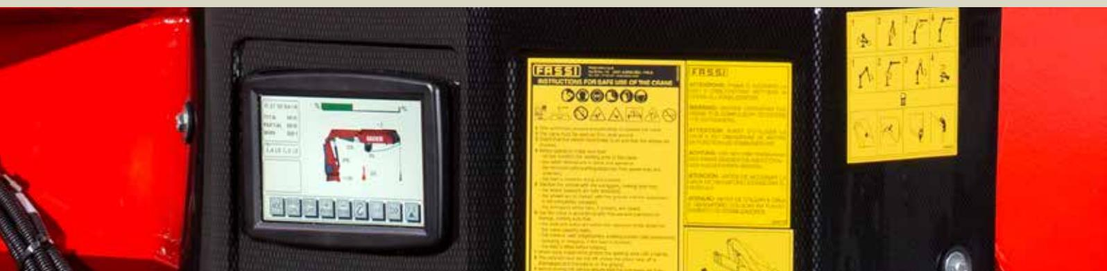
In fase di stabilizzazione compare in modo automatico una schermata dedicata, sempre consultabile premendo il virtual button stabilizzatori quando si opera attraverso comandi manuali o con radiocomando spento. La configurazione di gru, stabilizzatori e settori rispecchia la realtà. Ogni elemento viene disegnato in funzione dello stato in cui si trova in quell'istante.
