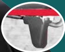
Sensore di prossimità. Verifica dell'appoggio sul terreno dei martinetti stabilizzatori.
