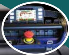
Radiocomando digitale di nuova generazione esclusivamente abbinabile al prodotto Fassi, con ampio display grafico, per il controllo a distanza delle funzioni della gru.
