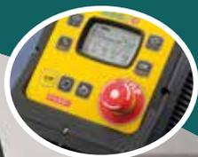
Dispositivo elettronico. Gestisce il momento di sollevamento dando la possibilità di attivare diverse zone di lavoro rispetto alle condizioni di stabilità dell'unità veicolo/gru. Inoltre, trasmette e registra i dati di lavoro.
