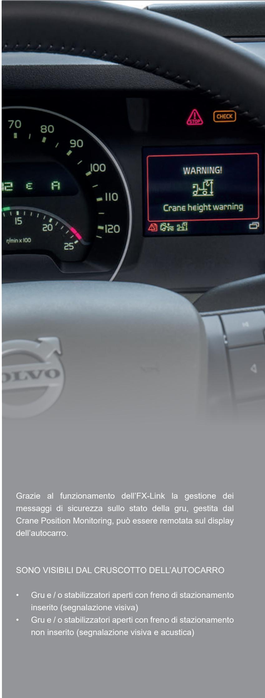
Grazie al funzionamento dell'FX-Link la gestione dei messaggi di sicurezza sullo stato della gru, gestita dal Crane Position Monitoring, può essere remotata sul display dell'autocarro.
