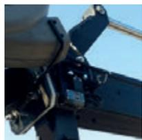
La norme EN 280:2015 établit que les plateformes interchangeables doivent être fixées et interverrouillées sur la structure extensible. Par conséquent, un axe qui fixe la plateforme à la grue est nécessaire, avec en plus un contrôle électronique de la présence de cet axe.
