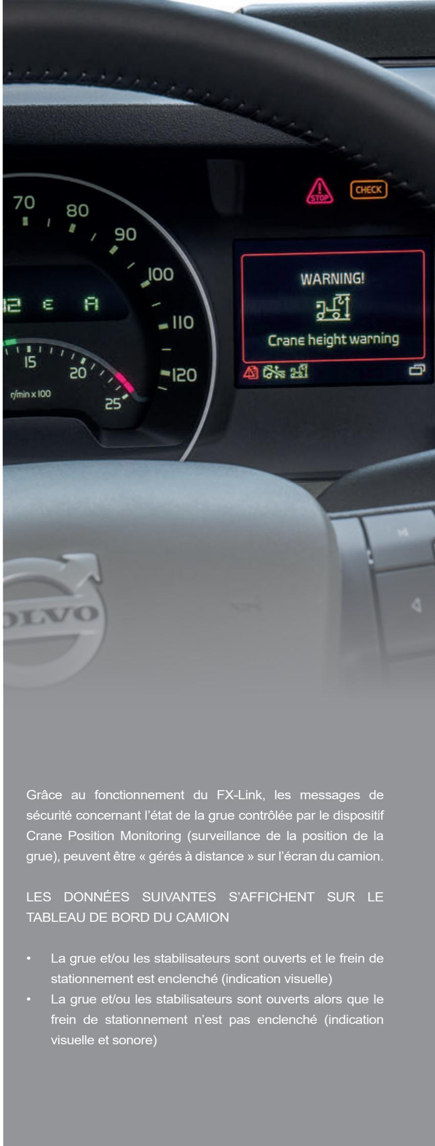
Grâce au fonctionnement du FX-Link, les messages de sécurité concernant l'état de la grue contrôlée par le dispositif Crane Position Monitoring (surveillance de la position de la grue), peuvent être « gérés à distance » sur l'écran du camion.
