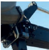
La normativa EN 280:2015 establece que las plataformas intercambiables deben bloquearse e interbloquearse en la estructura extensible. Esto significa que, además de un perno que bloquee la plataforma a la grúa, es necesario un control electrónico de la presencia de tal perno.
