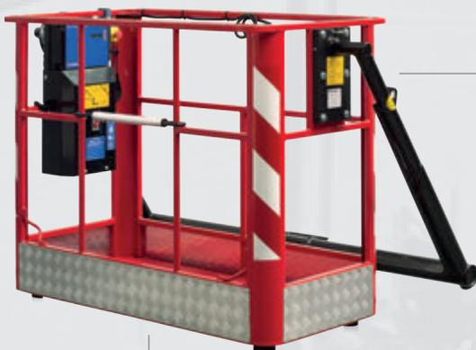
La unidad de control de la cesta verifica la inclinación. Niega el permiso para trabajar si la inclinación de la cesta va más allá del RANGO  $-10^{\circ}+10^{\circ}$ .
