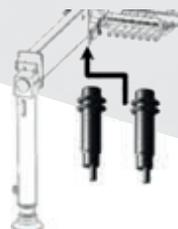
La identificación de la condición de gato estabilizador en el suelo se solicita con la instalación de un segundo sensor de proximidad, cuya sede ya está predispuesta en todos los travesaños de la grúa y en los adicionales.
