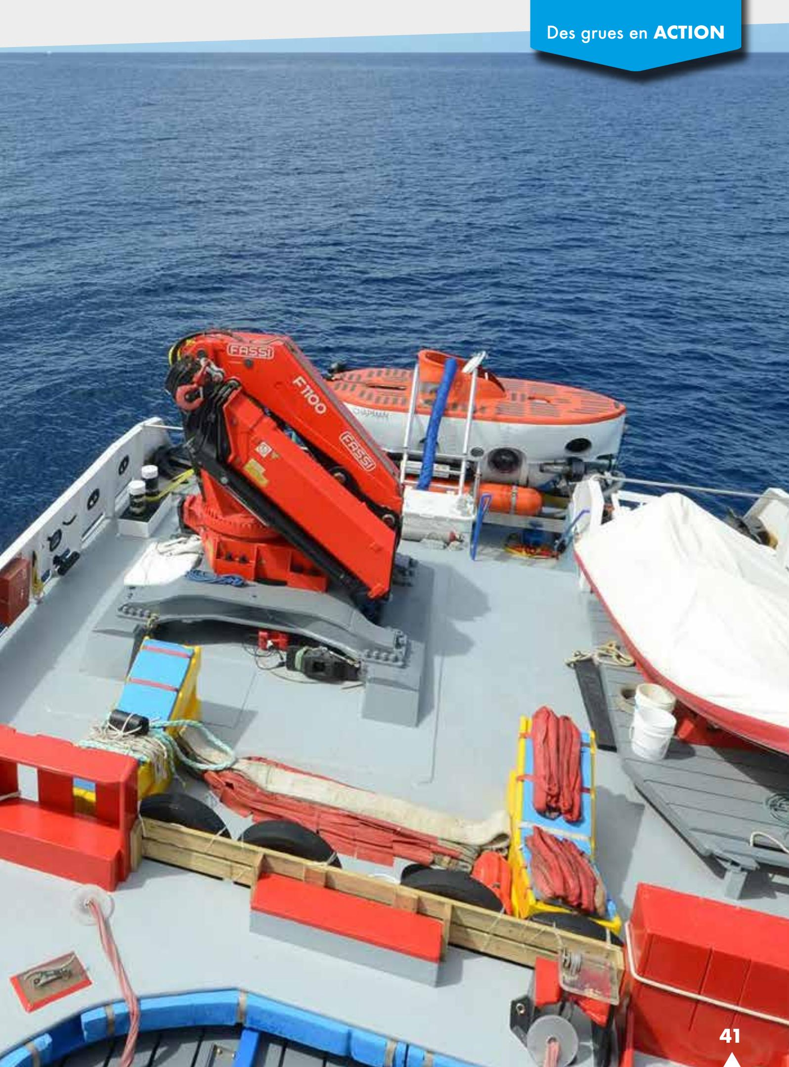
Fassi s'est rendu à la Substation Curacao située dans les eaux magnifiques de la Mer des Caraïbes. Ceci a eu lieu avec sa grue F1100RA, d'une capacité de levage de 110 tonnes, et ce qu'elle a remonté du littoral de Curaçao est vraiment unique.
