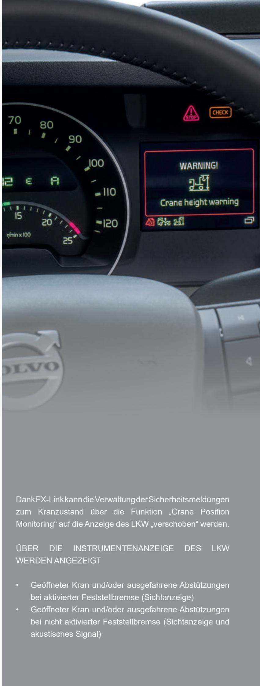
Dank FX-Link kann die Verwaltung der Sicherheitsmeldungen zum Kranzustand über die Funktion „Crane Position Monitoring“ auf die Anzeige des LKW „verschoben“ werden.
