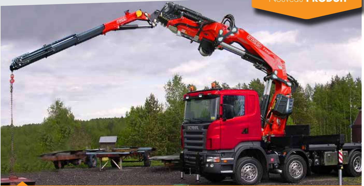
La F990RA en action. La nouvelle grue Fassi est équipée du système électronique FX900 et de l'écran FX901
