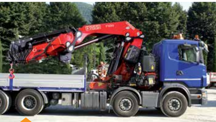
La F1550RA propose une capacité de levage de 123.13 tm
