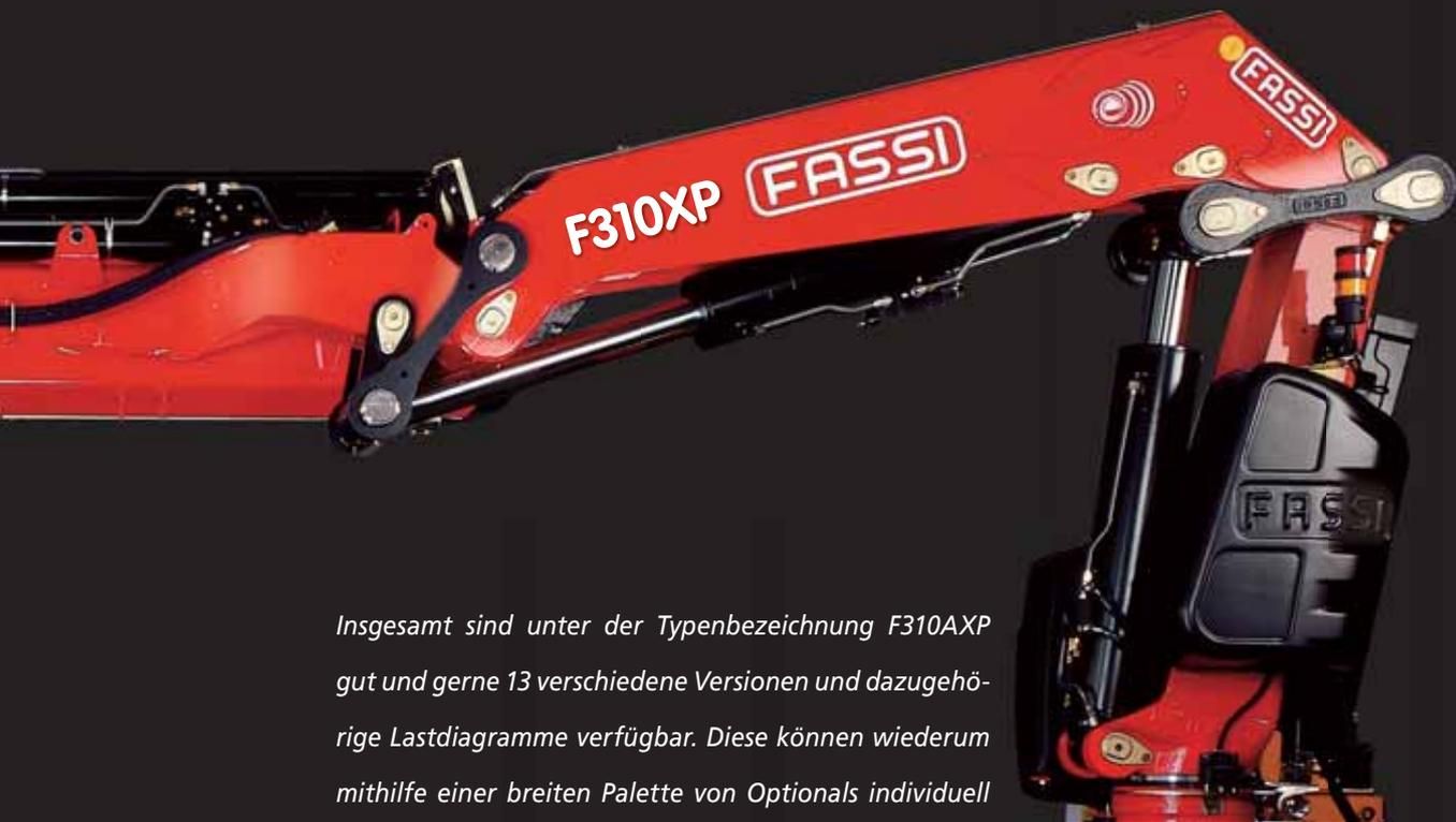
*Insgesamt sind unter der Typenbezeichnung F310AXP gut und gerne 13 verschiedene Versionen und dazugehörige Lastdiagramme verfügbar. Diese können wiederum mithilfe einer breiten Palette von Optionals individuell ausgestaltet werden und damit im Hinblick auf Hydraulik, Armgelenke, Wärmeregulierungsmechanismen und Steuerbefehle variiert werden.*
