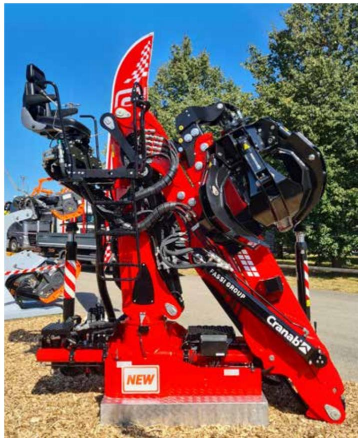
lavoro. Non dobbiamo dimenticare la semplicità dei sistemi di sicurezza obbligatori per il mercato CE; anche questi come la gru stessa sono “Made in Fassi”. Sistemi in grado, mediante il limitatore FX200 e il sistema di controllo stabilità FSC proposto nelle varianti L ed M1, di tutelare l'operatore senza pregiudicare velocità, operatività in aree ristrette dove non si possono estendere tutti gli stabilizzatori, e non ultima la piena capacità di sollevamento.
