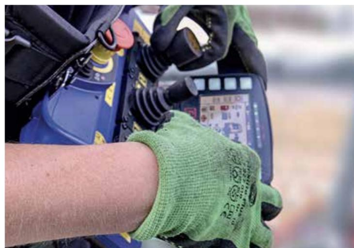
Il sistema è caratterizzato da due linee CAN-BUS di comunicazione in modo tale che i due mezzi dialoghino correttamente e in piena sicurezza. In questo modo ad esempio, **con il radiocomando della gru è possibile spegnere e accendere l'autocarro, regolare il regime del motore, accendere i fari e altri indicatori luminosi, attivare il clacson per segnalare un pericolo imminente.**
