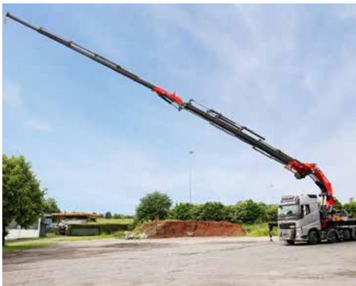
F1650RA, an der Reihe. Auch dieser musste unter denselben Platzverhältnissen abgeladen werden. Der größere und schwerere Kran mit 15 Tonnen erforderte höchste Konzentration von allen Anwesenden. Er wurde ohne große Schwierigkeiten vom Sattelanhänger gehoben. Die Genauigkeit und die perfekte Kontrolle der Bewegungen des F1650RA hat die Anwesenden überzeugt und die hervorragende Leistungsfähigkeit bestätigt, die dieser Kran in den unterschiedlichsten Situationen erreichen kann.
