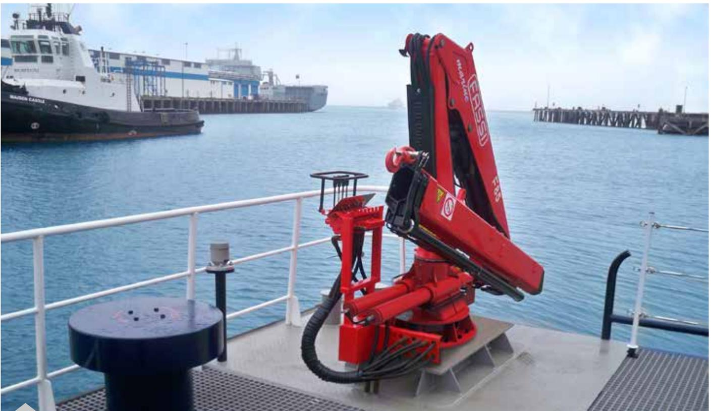
Las grúas equipadas con una cremallera doble pueden superar el límite de inclinación de 5° impuesto por las condiciones de un mar agitado
