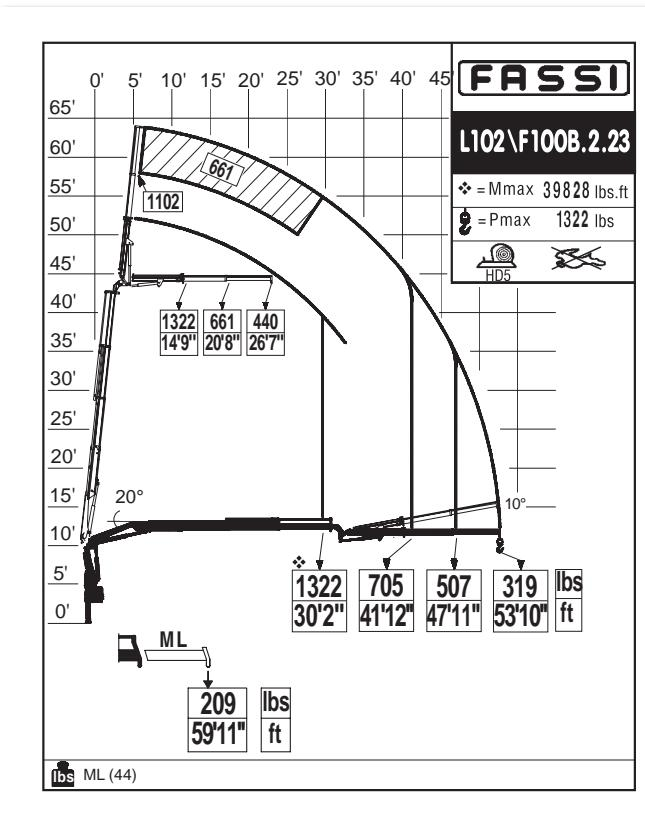
Crane belonging to the HC1 HD5 S2 class (if installed on truck) according to EN 12999:2011 - Grue appartenant à la classe HC1 HD5 S2 (s'il est installé sur le camion) selon la norme EN 12999: 2011 - Grúa que pertenezca a la clase HC1 HD5 S2 (si está instalado en el camión), de acuerdo con la norma EN 12999:2011
