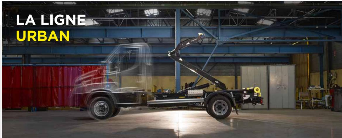
Une gamme conçue pour les artisans, les PME et les collectivités locales. Elle peut être installée sur des véhicules utilitaires légers et des camions jusqu'à 7,5 tonnes. La conception et l'utilisation d'aciers à haute résistance réduisent le poids du bras hydraulique Ampliroll®, ce qui en fait l'un des plus légers du marché. Cela augmente la charge utile et améliore la productivité.
