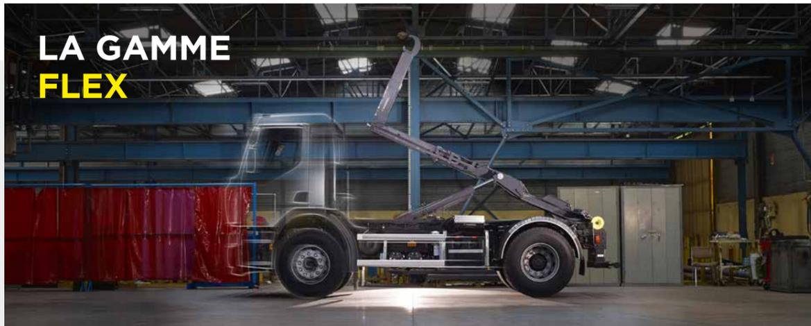
Le modèle Flex apporte une grande polyvalence aux chariots rigides légers. Réputé pour sa légèreté, le chariot à crochet Ampliroll® offre une capacité de charge utile accrue et de meilleures performances. La forme du bras coulissant permet de s'adapter à une grande variété de longueurs de caissons. Plusieurs modèles de crochets sont disponibles : à hauteur différente ou à réglage hydraulique (selon la puissance).
