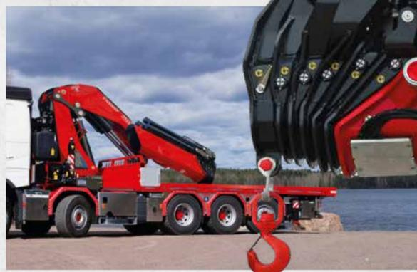
**de guidage et la poutre du châssis,** d'ainsi réduire l'épaisseur de cette dernière et, par conséquent, de diminuer le poids total de la grue. L'optimisation du poids a deux effets importants : d'une part, les performances de la grue sont accrues, d'autre part, une meilleure capacité de charge bénéficie à la consommation de carburant lorsque le véhicule est à vide, ce
